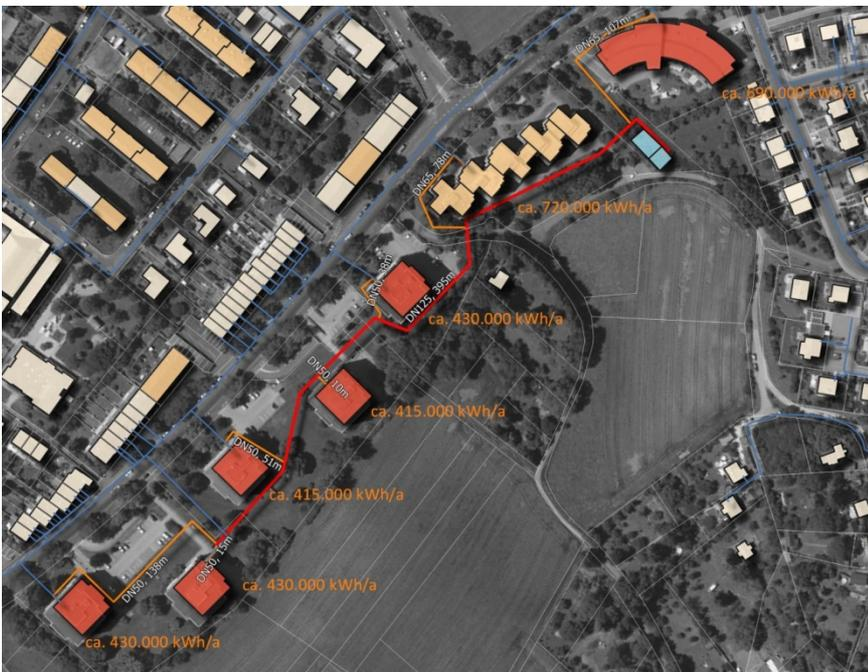
**Abbildung 69: Beispielhaft berechnetes Nahwärmenetz in der Elsa-Brändström-Str.**
